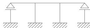
図 11.6.2 2基以上の下部構造が剛結される上部構造を有するラーメン橋の例
