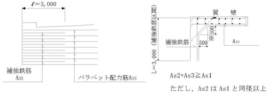
図 3.5.7 ウィング付け根部の補強
