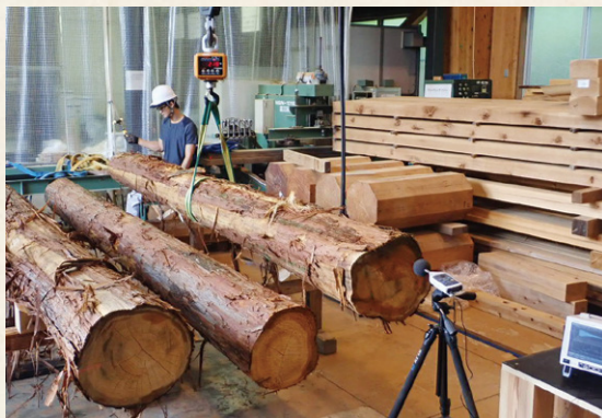
図2 丸太ヤング係数の測定
