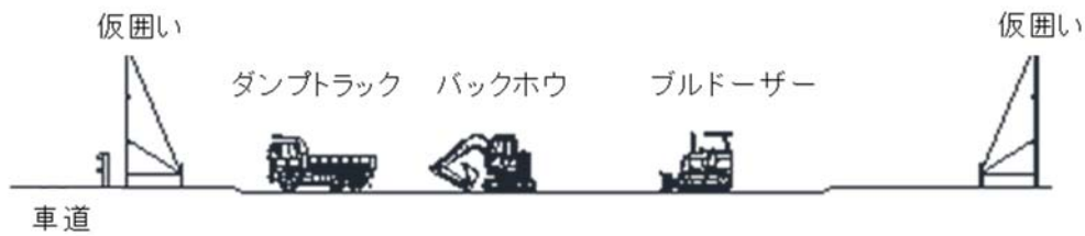
図 2-4(1) 瑞浪市内土岐町発生土仮置き場における主な施工手順（土地の整地）
