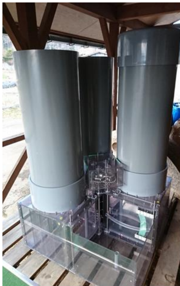
タンク式小水力発電施設
