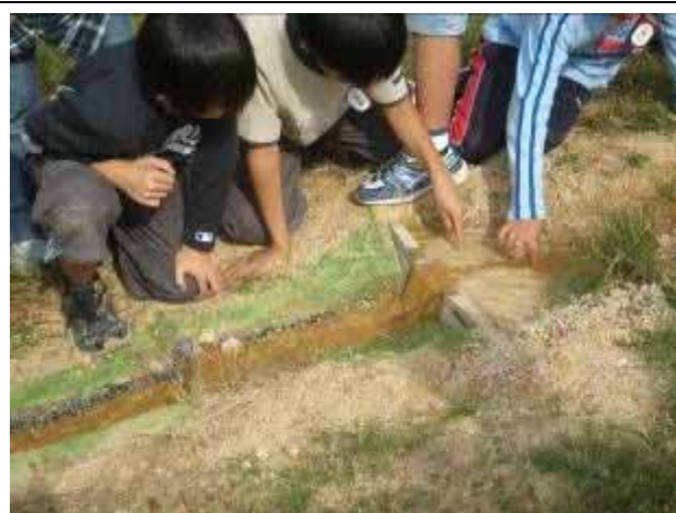
砂防実験(砂防えん堤) S=1/100
