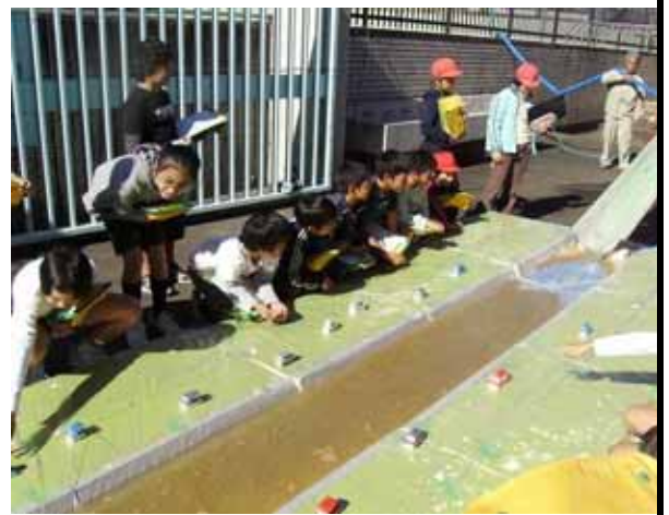
(工事前後の模型実験) 工事前と工事後の模型により水が溢れる時間や砂の動き方を実験しました。
