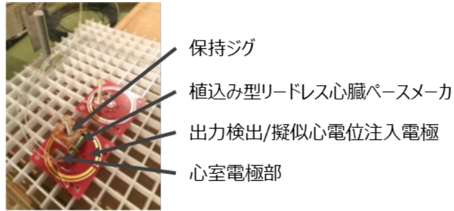
図 1-5 人体ファントム内の植込み型リードレス心臓ペースメーカーの配置状態
