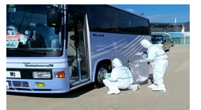
(写真 5-4) 拭き取りによる除染 (車両)
