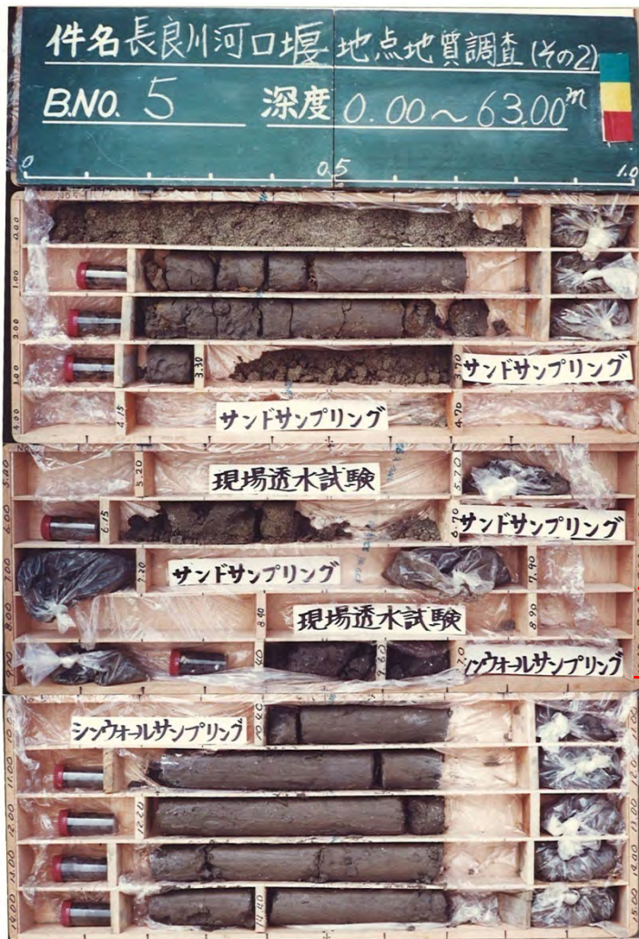
堰運用前(S63)のボーリング調査資料:0~15m
