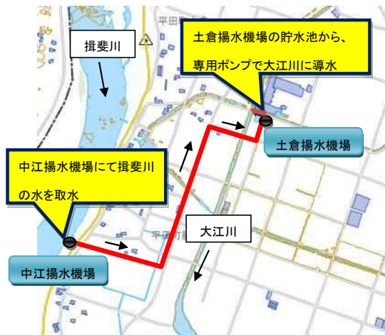
図 2.1 揖斐川から大江川への導水系統
