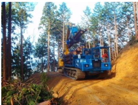
高性能林業機械による集材作業
