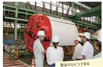
製品のひとつである トンネル掘削機。
