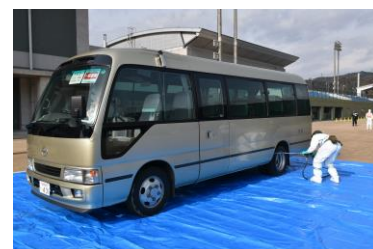
(写真5-3) 陸上自衛隊による車両除染
