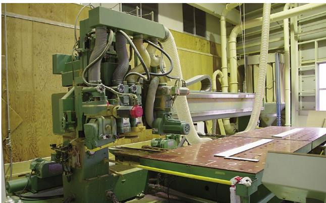
多様な加工に対応できるようルーター軸、カンナ軸、ノコ軸、水平ルーター軸を備えた大型ツインテーブルの2台のNCルーターは、2600×1600mmのテーブル上に別々の加工物をセットして加工ができ、大きな加工物に対しては2台のテーブルを同調して加工することも可能です。
