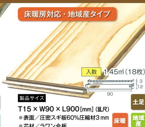
安心・安全な複合タイプのフローリングです。公共施設に最も多く実績があります。床暖房に対応しているオールラウンダーです。表面3mmはムク材ですので施工後の仕上がりは、限りなくムクに近いです。表面単板に使用されているスギ60%圧縮材は、ナラ材の2倍程度の硬さです。
