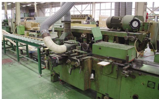
ドイツ・ヴァイニッヒ社製のモルダーを7軸1台と5軸4台保有しており、製材された材料から一度の作業で4側面のプレーナー仕上げが完了するマシンです。
