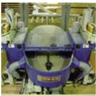
加工物の大きさや加工寸法をタッチパネルに数値入力するだけで、自動で小口スリットの加工をする機械です。スリット深さを一定率で可変でき、登り梁等にも対応できます。600mmまでの加工物に最大300mmの深さのスリット加工ができます。
