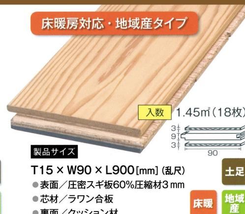
複合フローリングの直貼タイプです。表面3mmはムク材ですので施工後の仕上がりは、限りなくムクに近いです。表面単板に使用されているスギ60%圧縮材は、ナラ材の2倍程度の硬さです。
