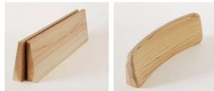
平面圧縮だけではなく、圧縮と同時に曲げる技術を開発。曲面の加工により座り心地のよいチェアのデザインが可能となりました。
