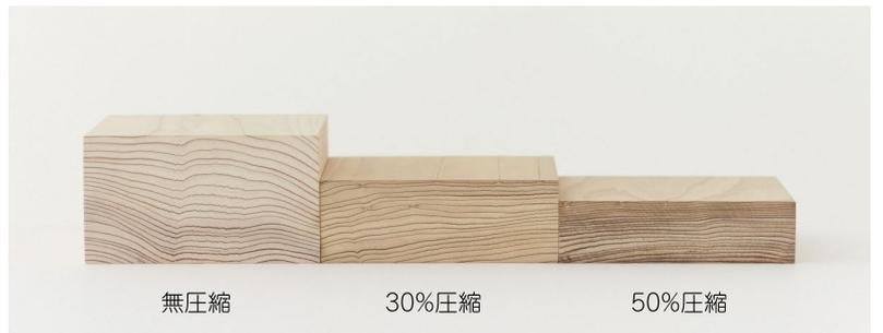
高含水率・高温状態(蒸煮)で木材組織を軟化させ加熱しながらプレス機で圧縮します。使用するのは水と熱のみ。薬剤などを一切使用しないので、安心・安全な技術です。
