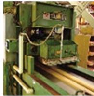
化粧貼り集成材の単板を連続接着するマシンで、長さ5500mmまでを一度のプレス作業で接着します。材質により温度設定を変えて、あらゆる要求に対応します。
