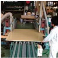
パネルを連続してカッティングするマシンで長さはエンドレスでカットを行い、送りキャタピラ上に浮上式のドックを備えていて直角方向のカッティングも行えます。
