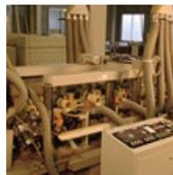
当社独自のオリジナルマシンで、ホットプレスにより単板接着された材料の単板のはみ出し部分「耳」を、材料の厚みや巾寸法を自動計測して連続して耳取りサンディングを一度の作業で行うマシンです。作業者はキャタピラチェーンの上に材料を置く作業のみで寸法セットも全自動です。
