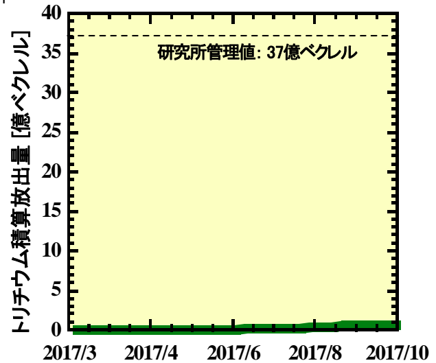
排気塔からのトリチウム 積算放出量(2017年3月~10月)
