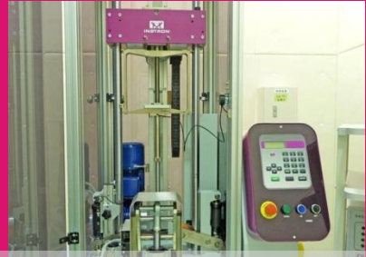
落錘型衝撃試験機 CEAST9350型 Instron Corporation
