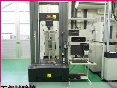
万能試験機 5985型 Instron Corporation
