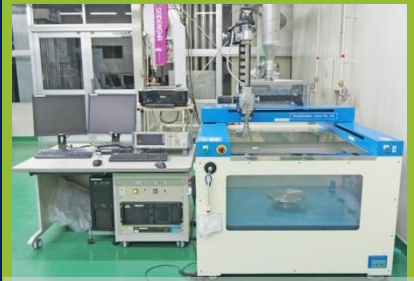
超音波検査装置 SDS-Win 6600RAM 日本クラウトクレマー(株)
