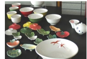
950℃で焼成した磁器製品 (エネルギー約40%削減)
