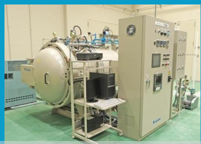
小型オートクレーブ AC-900×1000L (株)芦田製作所
