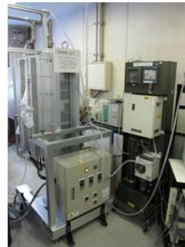
白金を約75%削減した VOC処理装置
