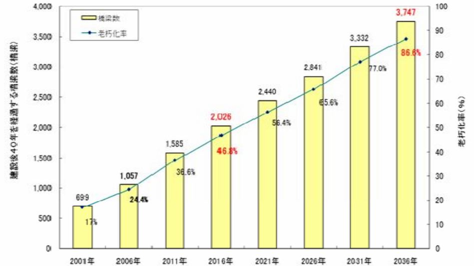
老朽化する橋りょうの状況(岐阜県)
