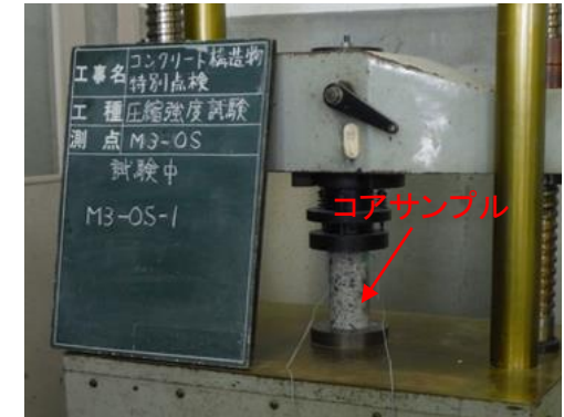
強度の点検事例 (耐圧試験機による確認)
